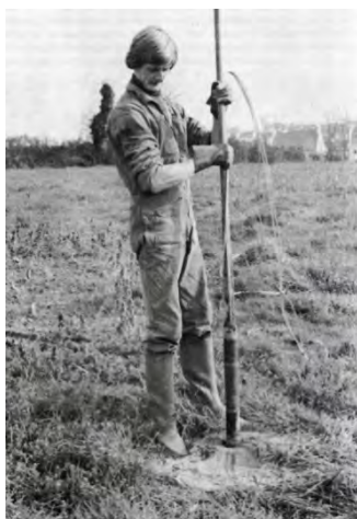
Εισαγωγή του πρεσσομετρικού στελέχους στη γεώτρηση
