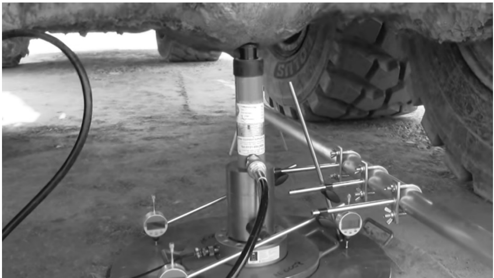
Δοκιμή φόρτισης πλάκας
