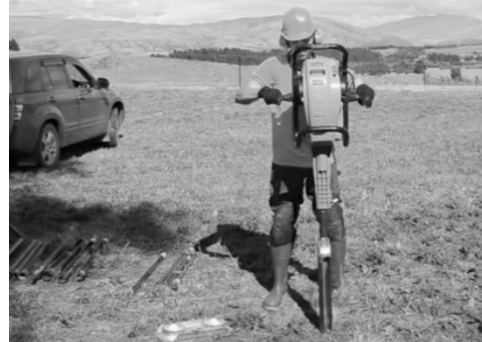
Γρήγορη δειγματοληψία με βενζινοκίνητη δονητική σφύρα και δειγματολήπτη με παράθυρο
