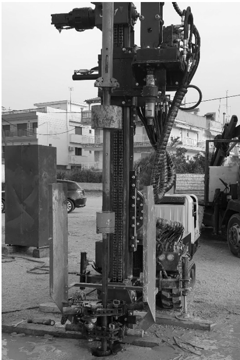
Πρότυπη δοκιμή διείδυσης (SPT). Αυτοματοποιημένη διάταξη. Εξασφαλίζει σταθερό ύψος πτώσης
