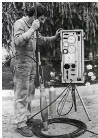
Έλεγχος της λειτουργίας διαστολής του πρεσσομετρικού στελέχους πριν την εκτέλεση της δοκιμής
